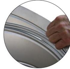
Encaixar o anel de inclinação nº 2 (vinco para dentro) com o anel de inclinação nº 1 (vinco para fora), em todo o perímetro.
